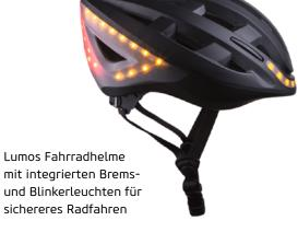
integrierte Beleuchtung. Mithilfe eines Beschleunigungssensors erkennt der Helm eine Verringerung der Geschwindigkeit und zeigt diese mit dem Bremslicht an. Auch Handzeichen werden durch den smarten Helm überflüssig. Geplante Richtungswechsel können drahtlos über die Lenkerstange oder per Gestensteuerung an den Helm gesendet werden. Dieser reagiert mit dem jeweiligen Blinker hinten und seitlich am Helm.
